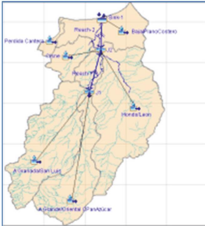
Figura 2.23. Modelo de la Cuenca de la Ciénaga de Mallorcaín cargada en el software HEC-HMS
