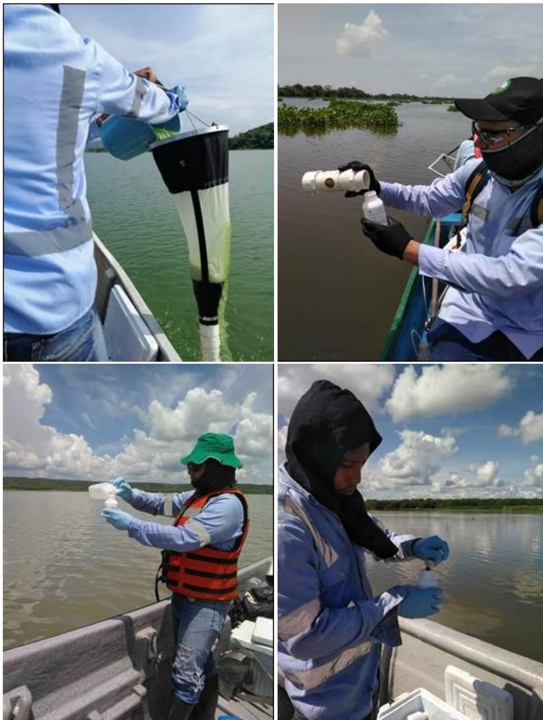
Fotografía 6-2. Procedimiento de colecta de fitoplancton. A) Filtrado de volumen conocido en malla de 20-25 micras, B) Trasvaso a recipiente colector, C) Preservación con formalina y D) Tinción con lugol
