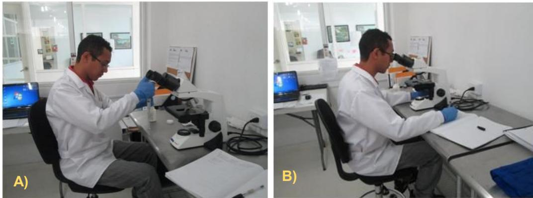
**Fotografía 6-10. Procesamiento de muestras de fitoperitton. A) Montaje de la muestra de fitoperitton por el método de Lackey, B) Identificación y conteo de las microalgas en el microscopio binocular**
