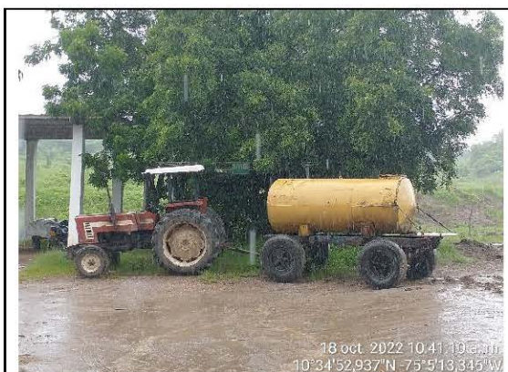
FOTO No. 7 Tomada el 18 de octubre de 2022 Observaciones: Tractor y tanque para transportar agua captada del “jagüey”, mecanismo de riego de vías internas en época de sequía.
